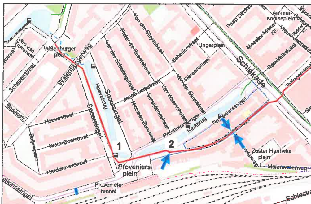
Figuur 18: stelsel met overstorten, collecteurriool en koppelleiding
